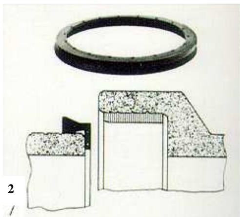
**Fig. 2** - Anello utilizzato come anello di tenuta sulle estremità di tubi tagliati e di pezzi speciali da collegare a bicchieri con giunto poliuretano.
