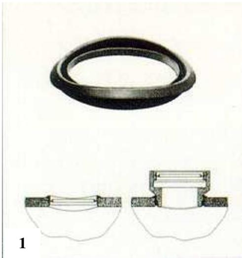
**Fig. 1** - Anello utilizzato per la giunzione di una diramazione a testata liscia ad un collettore esistente.
