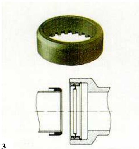
**Fig. 3** - Anello utilizzato per collegare tubi di gres con bicchiere all'estremità di tubi di ghisa o PVC.
